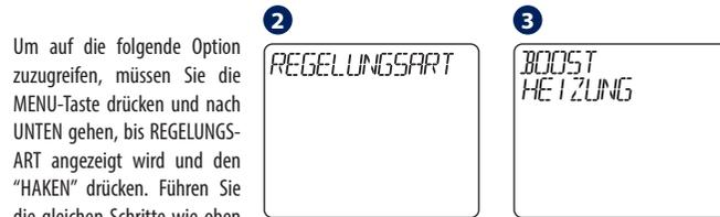
Um auf die folgende Option zuzugreifen, müssen Sie die MENU-Taste drücken und nach UNTEN gehen, bis REGELUNGSART angezeigt wird und den „HAKEN“ drücken. Führen Sie die gleichen Schritte wie oben gezeigt aus, um auf das Menü BOOST HEIZUNG zuzugreifen.
