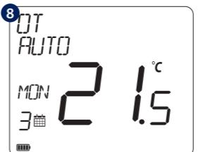
Po správném připojení termostatu ke svrkám OpenTherm se na obrazovce zobrazí zpráva OT. Další podrobnosti o OpenTherm najdete v sekci OpenTherm: konfigurace.
