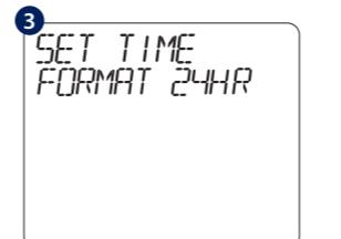
Pomocí tlačítka NAHORU nebo DOLŮ zvolte formát času mezi 24 hodinami a 12 hodinami.
