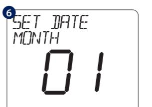
Pomocí tlačítka NAHORU nebo DOLŮ nastavte měsíc a poté stiskněte tlačítko POTVRZENÍ. Poté stejným způsobem nastavte den.
