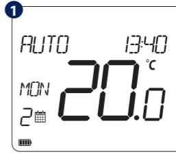
Pomocí tlačítka NAHORU nebo DOLŮ, přejděte do podnabídky Advanced settings (pokročilá nastavení) a stiskněte tlačítko POTVRZENÍ.
