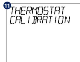
Si cree que la temperatura que se muestra en el termostato no es precisa debido a su ubicación, puede calibrarla usando este menú con valores entre -3,5 / +3,5 grados.
