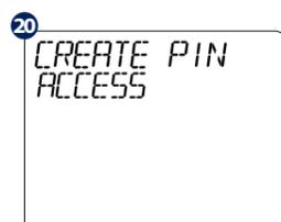
Le permite crear un PIN que puede usarse para limitar el acceso a su configuración. Usando ARRIBA o ABAJO, cree su acceso PIN, luego Haga clic para confirmar.
