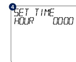
Usando ARRIBA o ABAJO, configure la hora y luego presione TICK, para continuar con los minutos, que se pueden cambiar de la misma manera.
