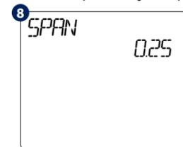
Este es un simple algoritmo de control de ENCENDIDO / APAGADO basado en el punto de ajuste. Usando ARRIBA o ABAJO, puede seleccionar el valor de SPAN. Presione TICK para confirmar o BAJAR para ir a la siguiente opción.
