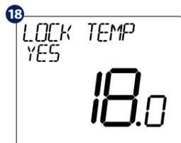
Usando ARRIBA o ABAJO, seleccione la temperatura de bloqueo caducado el período de mantenimiento y luego presione TICK.
