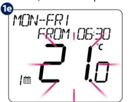
Usando ARRIBA o ABAJO, configure la temperatura que desea para ese intervalo horario y luego presione TICK para confirmar. Repita este proceso para los 6 programas.
