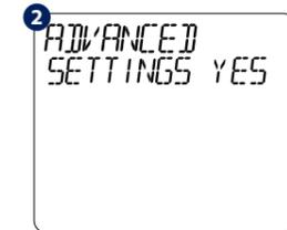
Usando ARRIBA o ABAJO, navegue hasta el submenú Avanzado y presione TICK.
