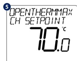
Usando ARRIBA o ABAJO, configure el valor y luego presione TICK durante 3 segundos para confirmar y salir a la pantalla principal.
