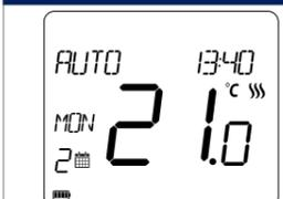
Para anular el valor de la temperatura grabada en una franja horaria de modo temporal. Use los botones de ARRIBA O ABAJO según desee aumentar o disminuir la temperatura. Seguido presione TICK para confirmar.
