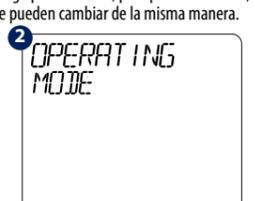
Puede elegir: AUTOMÁTICO: sigue la programación, ENCENDIDO 24/7: MANUAL, APAGADO (MODO antihielo).
