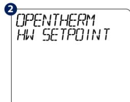
Usando ARRIBA o ABAJO, navegue hasta ACS punto de ajuste y presione TICK.
