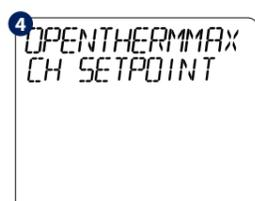
Presione TICK para entrar al menú. Usando ARRIBA o ABAJO, configure la temperatura máxima de generador de calor de opentherm.
