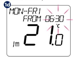
Usando ARRIBA o ABAJO, configure la hora y luego presione TICK, para pasar a minutos, que se pueden cambiar de la misma manera.
