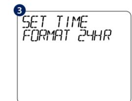
Usando ARRIBA o ABAJO, elija el formato de hora entre el formato de 24 horas o 12 horas.
