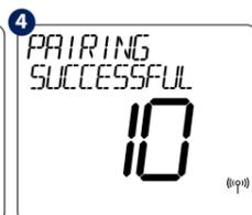
Al conectarse al receptor, el termostato mostrará el mensaje "EMPAREJAMIENTO EXITOSO" y luego volverá al funcionamiento normal. El LED rojo dejará de parpadear cuando el emparejamiento se realice correctamente.
