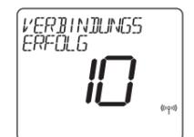
Jetzt sendet Ihr Thermostat eine TEST-Nachricht an den Empfänger mit der Erwartung, eine Antwort zu erhalten. Während des Tests blinken sowohl die rote als auch die grüne LED zeitweise.
