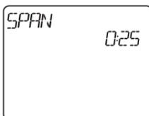
Dies ist eine einfache Ein / Aus-Algorithmus-Steuerung basierend auf dem Sollwert. Mit AUF oder AB können Sie den SPAN-Wert auswählen (0,25K oder 0,5K). Drücken Sie den "Haken" zur Bestätigung oder AB, um zur nächsten Option zu gelangen.
