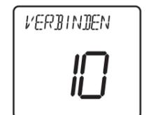
Jetzt sucht Ihr Thermostat nach dem Empfänger. Auf dem Bildschirm wird ein 10-Minuten-Zähler angezeigt.
