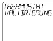
Wenn Sie der Meinung sind, dass die auf dem Thermostat angezeigte Temperatur aufgrund seiner Position nicht genau ist, können Sie sie über dieses Menü mit Werten zwischen -3,5 / +3,5 Grad kalibrieren.
