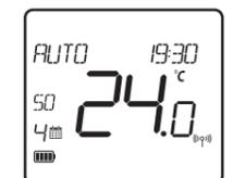
Nach dem Verbinden des Empfängers kehrt der Raumthermostat zum normalen Betrieb zurück. Die rote LED hört auf zu blinken, wenn das Pairing erfolgreich ist.
