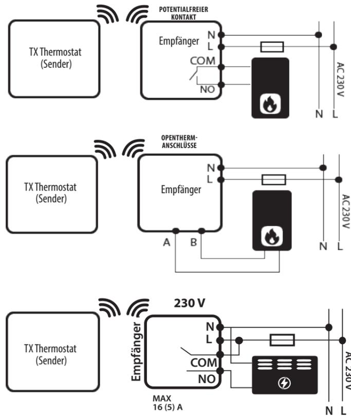
**ACHTUNG:** Sie schalten bei diesem Schaltplan AKTIV 230V. Stellen Sie sicher, dass die elektrische Heizung RICHTIG verkabelt ist. Es kann sonst zur Zerstörung diverser Komponenten führen, bis hin zur Überhitzung mit Feuer!
