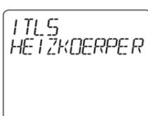
ITLC hilft, die Systemeffizienz und den Nutzerkomfort zu verbessern. Standard ist ITLC Heizkörper (deaktiviert, wenn Opentherm angeschlossen ist). Drücken Sie den "Haken" zur Bestätigung oder AB, um die nächste Option anzuzeigen.
