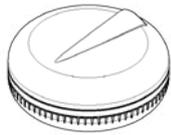
Coloque o sensor em uma superfície onde a água provavelmente vai acumular em caso de vazamento.
