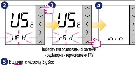
Виберіть тип опалювальної системи - радіаторна - термоголовки TRV
