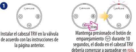
**Nota:** El siguiente ejemplo muestra el proceso de emparejamiento con el termostato VS10/20..RF. Para los termostatos HTRS-RF (30) y HTRP-RF (50), el proceso de emparejamiento debe hacerse de la misma manera.
