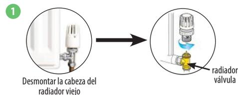
**Nota:** Si todas las dimensiones de la válvula son consistentes con las indicadas a continuación, entonces la cabeza TRV será compatible. Si hay diferencias de dimensiones, contáctenos o al instalador para encontrar el reemplazo de la válvula.
