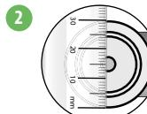
Izmerite dimenziju navoja. Navoj za TRV10RFM treba imati prečnik 30 mm, a za TRV28RFM - 28 mm.
