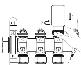
Установите сервопривод на терmostatickem клапане обратной гребёнки коллектора тёплого пола. После установки убедитесь, что вы надёжно закрепили сервопривод на коллекторе. Чтобы максимально облегчить установку сервопривода. Сервопривод поставляется изготовителем в полностью открытом состоянии.
