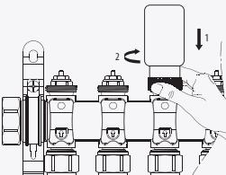
Připojte auto-balanční servopohon na termostatické ventily podlahového vytápění, které jsou na liště rozdělovače. Při instalaci servopohonu THB23030 / THB2430 se ujistěte že je zcela utažen na ventilu. Po vybalení z krabice je servopohon v plně otevřené poloze pro snadnou instalaci.
