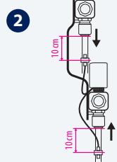
Inserte los dos sensores de temperatura en la tubería, uno en el tubo de impulsión y el otro en el tubo de retorno.
