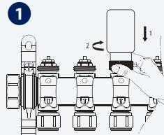
Montieren Sie den Abgleichsantrieb auf das Ventil im Rücklauf. Stellen Sie sicher das der Antrieb richtig fest sitzt. Der Antrieb ist im Auslieferzustand voll geöffnet um eine einfache Montage zu gewährleisten.
