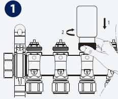
Instale el actuador de equilibrio automático en las válvulas termostáticas del colector de calefacción por suelo radiante, en la barra de retorno. Al instalar el THB23030 / THB2430, asegúrese de que esté completamente roscado en el colector de forma manual, no es necesario apretarlo con llave. El actuador está en posición abierta, listo para una fácil instalación.
