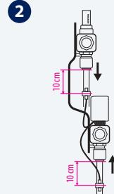
Befestigen sie die beiden Temperaturfühler am Vor und Rücklauf. Stellen Sie sicher das diese nach vorne zeigen und mindesten 10cm unterhalb des Verteilers angebracht sind.
