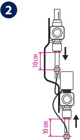
Insira os dois sensores de temperatura na tubagem, um no tubo de impulsão e o outro no tubo de retorno.
