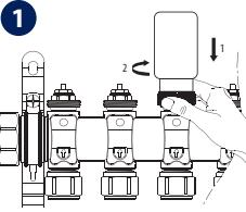
Instale o atuador de equilíbrio automático nas válvulas termostáticas do coletor de aquecimento por piso radiante, na barra de retorno. Ao instalar o THB23030 / THB2430, certifique-se de que esteja completamente rosqueado no coletor de forma manual, não é necessário apertá-lo com chave. O atuador está na posição aberta, pronto para uma fácil instalação.
