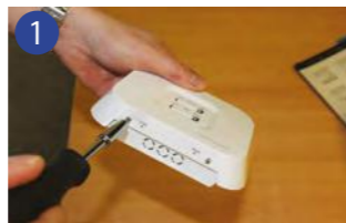
1 Χαλαρώστε τις βίδες στο κάτω μέρος του περιβλήματος του δέκτη.
