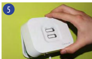
5 Επανατοποθετήστε το εμπρόσθιο τμήμα του δέκτη.
