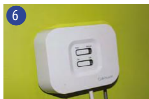
6 Σφίξτε τις βίδες που βρίσκονται στο κάτω μέρος του περιβλήματος του δέκτη.
