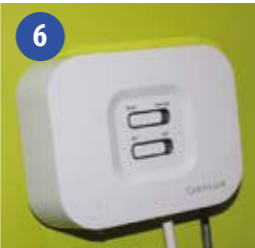
6 Затегнете винтовете от долната страна на корпуса на приемника.
