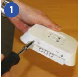
1 Разхлабете винтовете от долната страна на корпуса на приемника.
