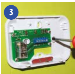
3 Фиксирайте задната част на приемника върху стената като използвате приложените монтажни винтове.
