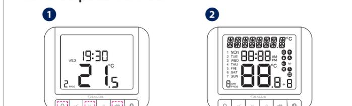
Pour réinitialiser le thermostat, appuyez simultanément sur MENU, Flèche Bas et +HR pendant 5 secondes.
