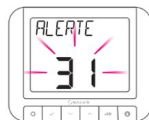
Une fois le mode propriétaire activé, l'appareil verrouille la température de consigne définie par l'installateur / propriétaire. Pour déverrouiller cet appareil, le propriétaire doit être contacté et la chaudière doit être entretenue.
