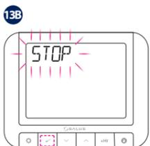
Optimum Stop calcule le temps de refroidissement de la maison, puis éteint la chaudière le plus tôt possible, ce qui signifie que le système ne fonctionne pas alors qu'il n'est pas réellement nécessaire. En cas de perte de chaleur soudaine pendant cette période, Optimum Stop sera annulé pour rétablir les conditions de confort.
