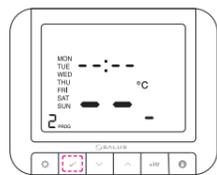
Lorsque des lignes apparaissent, appuyez sur SÉLECTIONNER pour confirmer l'intervalle de température supprimé
