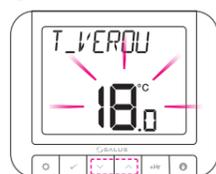
Utilisez Flèche Haut ou Flèche Bas, sélectionnez la température de verrouillage, puis appuyez sur Sélectionner.
