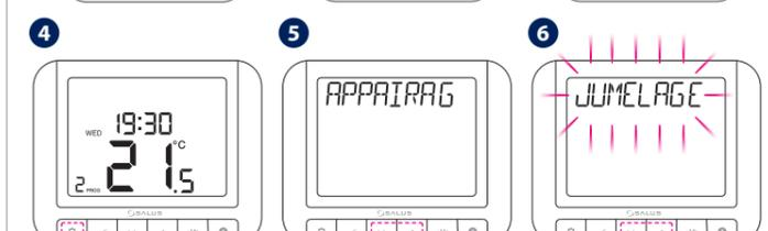
Appuyez sur MENU. Utilisez Flèche Haut ou Flèche Bas, accédez au sous-menu Appairage, puis appuyez sur Sélectionner. Utilisez Flèche Haut ou Flèche Bas, sélectionnez Jumelage, puis appuyez sur Sélectionner.
