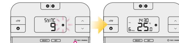
Sobald der Empfänger verbunden ist leuchtet die LED dauerhaft ROT. Um den Verbindungsprozess abzuschließen halten Sie TEST/PAIRING für 3 Sekunden gedrückt.
