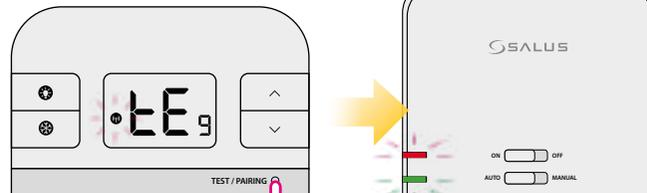
Drücken Sie kurz TEST/PAIRING zur Prüfung welche Sender / Empfänger miteinander verbunden sind. Die ROTE LED des verbundenen Empfängers fängt an zu blinken.
