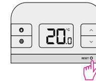
Um den Thermostaten auf Werkseinstellungen zurückzusetzen, drücken Sie bitte die RESET Taste.
