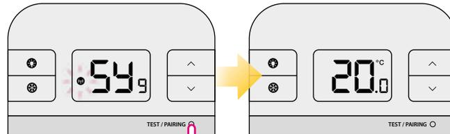
Sobald der Empfänger verbunden ist leuchtet die LED dauerhaft ROT. Um den Verbindungsprozess abzuschließen halten Sie TEST/PAIRING für 3 Sekunden gedrückt.
