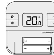
Nehmen Sie die Batterien heraus, ohne auf eine Taste zu drücken. Warten Sie 2 Minuten und setzen Sie dann die Batterien wieder ein. Ihr Gerät wird neu gestartet.
