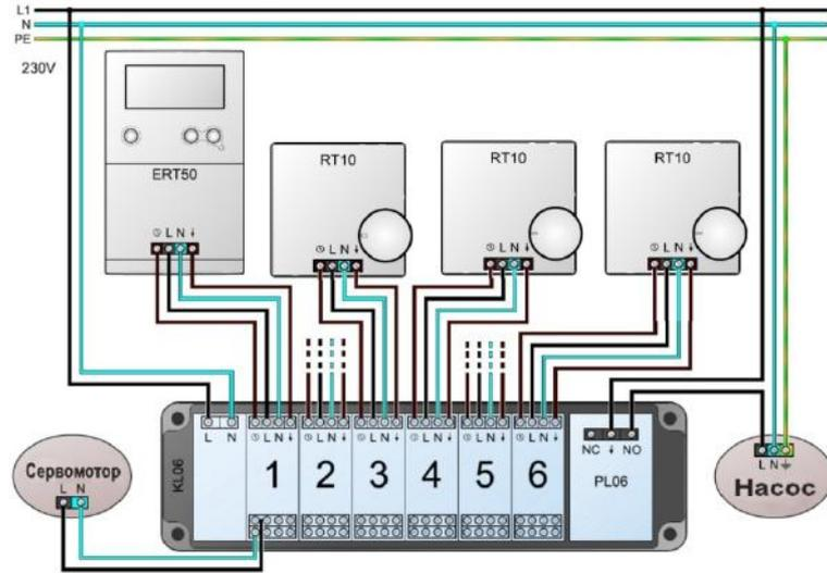
**Схема подключения 2**
