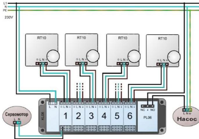
Каждая секция подключение к 4 сервомоторам
