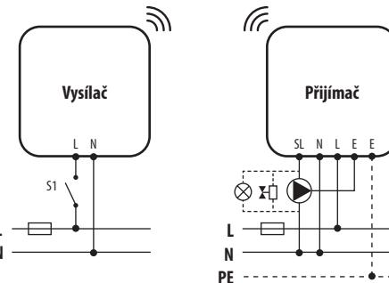
Když je kontakt vysílače S1 sepnut, na spínaném kontaktu vysílače (výstup SL) bude napětí 230V AC.
