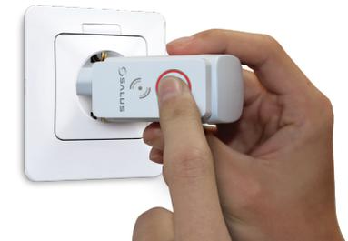
6 Drücken und halten Sie die Taste des Koordinators um den Pairing-Modus zu schließen. Die LED wird dann durchgehend Rot leuchten.
