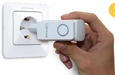
3 Drücken und Halten die die Taste des Koordinators für fünf Sekunden gedrückt um in den Pairing-Modus zu gelangen. Die Led blinkt dann Rot.
