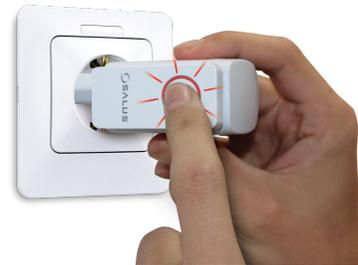
4 Stecken Sie den Repeater in die Steckdose. Die Taste wird Rot blinken.
