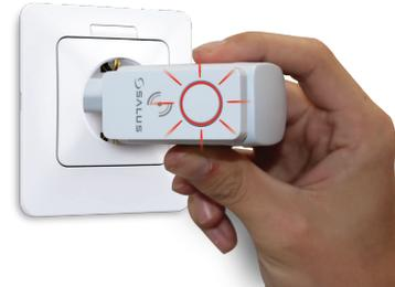
5 Drücken Sie die Taste des Repeaters. Die LED wird nun durchgehend Rot leuchten und zeigt an das dieser mit dem Netzwerk verbunden ist.
