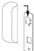
Coloque a caixa do sensor onde quiser e enrosque-a com os parafusos fornecidos.
