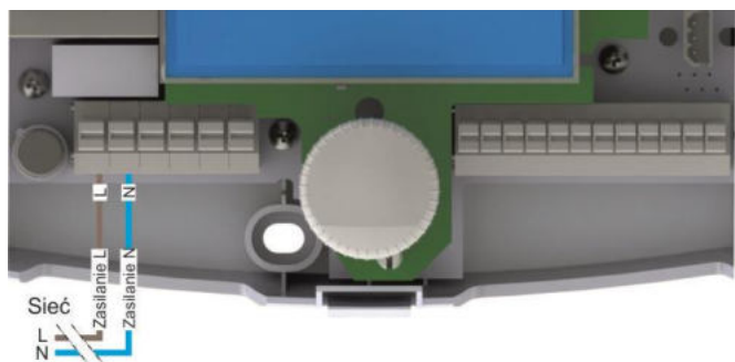
Rys. 16-5 Podłączenie zasilania sieciowego
