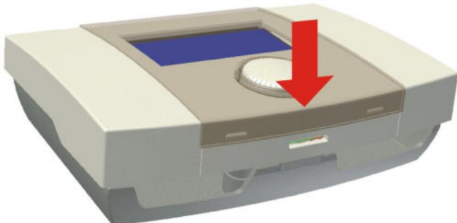
Rys. 18-2 Zamknięcie obudowy krok drugi
