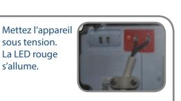
tension. Lorsqu'une zone demande de la chaleur, l'interrupteur de la chaudière se ferme provoquant le fonctionnement de
