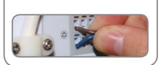
13 Fixez la bande de réduction des contraintes rouge à l'aide des trois vis pour fixer la pompe, la chaudière, le CO et les fils de mesure de point de rosée sur le côté inférieur du KL08RF.
