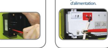
Enfoncez les câbles CO en bas à droite du KL08RF pour la commutation chauffage/rafraîchissement sans tension. Un interrupteur ouvert correspond au chauffage (LED rouge). Un interrupteur fermé correspond au refroidissement (LED bleue)
