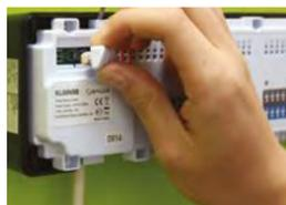
**13** Osigurajte vodove pumpe i bojlera korištenjem priloženih montažnih elemenata kako je pokazano na slici niže:
