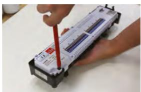
**6** Ponovo pritegnite glavni dio ekstenzora na stražnji dijelu kućišta.
