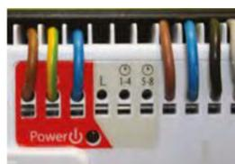
**15** Spojite napajanje ekstenzora - upalit će se crvena dioda.
