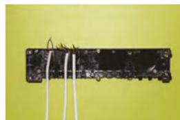
**9** Smjestite vodove termoelektričnih pogona na odgovarajuće kontakte kako je pokazano na slici niže. Ako vaš sustav zahtijeva spajanja s više od 4 pogona za jednu zonu grijanja, preporučamo korištenje dodatnog releja ili spajanje jednog regulatora na nekoliko zona na ekstenzoru - premošćivanjem vodiča sa simbolom SL.
