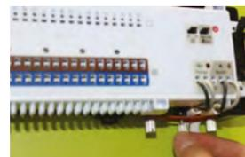
**3** Pričvrstite stražnji dio kućišta na zid ili šine DIN.
