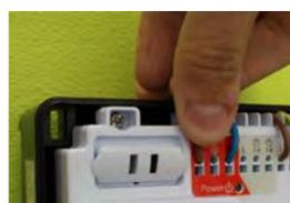
**11** Izbor tipa termoelektričnih pogona i funkcija kašnjenja spajanja bojlera (sklopke se nalaze s desne strane ekstenzora).
