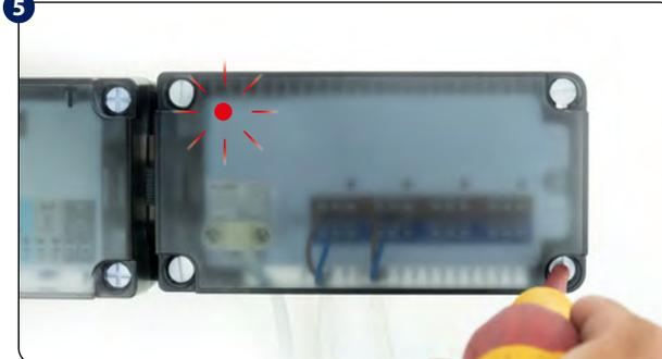
Uverite se da su sve žice pravilno povezane, vratite prednji poklopac centrale i pokrenuti centralu - "Napajanje" i "Povezanost" **crvene** LED diode će svetleti ako je sve pravilno povezano.
