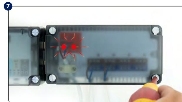
Uverite se da su sve žice pravilno povezane, vratite prednji poklopac centrale i pokrenuti centralu - "Napajanje" i "Povezanost" crvene LED diode će svetleti ako je sve pravilno povezano.
