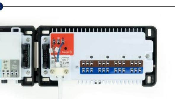
Provucite žice za napajanje i spojite ih na terminale "L" i "N".
