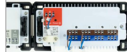
Spojite zice termoelektričnih pogona.
