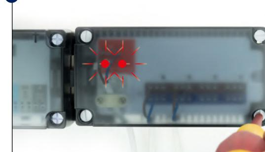
Provjerite da li su sve zice ispravno spojene, gornji poklopac stavljen, i ukljucite upravljačku traku - "Ukljuceno" i "Spojeno" crvene LED diode će se upaliti naznačujući da je ispravno spojena sa KL04RF upravljačkom trakom.
