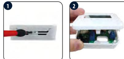
Ubezpečte sa, že termostat nie je pripojený k 230V AC. Pomocou skrutkovača otvorte predný kryt, ako je to znázornené vyššie.
