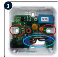
Termostat správne pripojte. Prečítajte si časť „Pripojenie termostatu“. Použite otvory určené pre skrutky.
