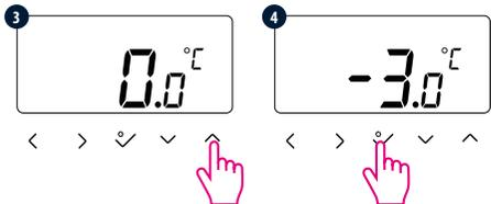
Nastavte hodnotu kalibrácie teploty pomocou tlačidla.
