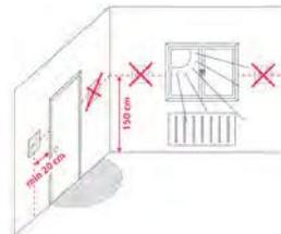
Ideálna poloha na montáž termostatu je približne 1,5 m nad úrovňou podlahy, ďaleko od zdrojov vykurovania alebo chladenia. Termostat neodporúčame inštalovať za záclony alebo iné prekážky – mohli by brániť presnému meraniu teploty v miestnosti. Termostat neinštalujte na miesta s vysokou vlhkosťou. Termostat nesmie byť vystavený slnečnému žiareniu. Neumiestňujte termostat na vonkajšiu stenu.
