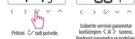
Izaberite servisni parametar korišćenjem < ili > tastera. Vrednost parametra se podešava pomoći  $\wedge$  ili  $\wedge$  tastera. Pritisnite  $\checkmark$  za potvrdu promene.
