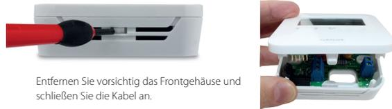
Entfernen Sie vorsichtig das Frontgehäuse und schließen Sie die Kabel an.
