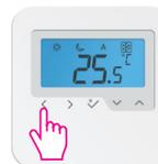
Bewegen Sie das Kästchen durch Antippen von oder auf das Symbol für den Frostschutzmodus. Das Gerät arbeitet dann im Frostschutzmodus.
