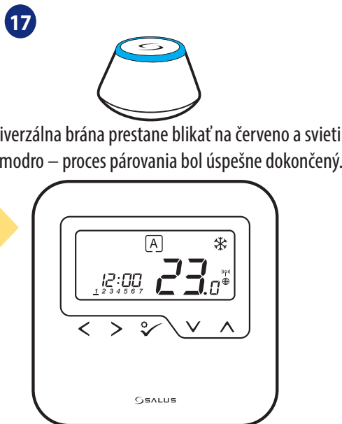
Následne termostat zobrazí hlavnú obrazovku. Úspešne ste spárovali termostat HTRP-RF(50) s inteligentným relé SR600.
