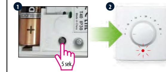
Nakon vraćanja tvorničkih postavki, regulator automatski ulazi u način rada uparivanja, koji traje maksimalno 2 minute. U načinu rada uparivanje, LED dioda sekvencijski treperi 3 puta bojom crvenom
