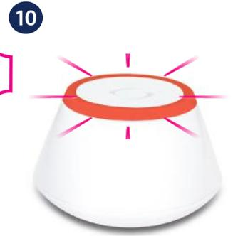
Сеть ZigBee открывается. Светодиод на интернет шлюзе мигает красным светом. Продолжается процесс поиска и добавление устройств.
