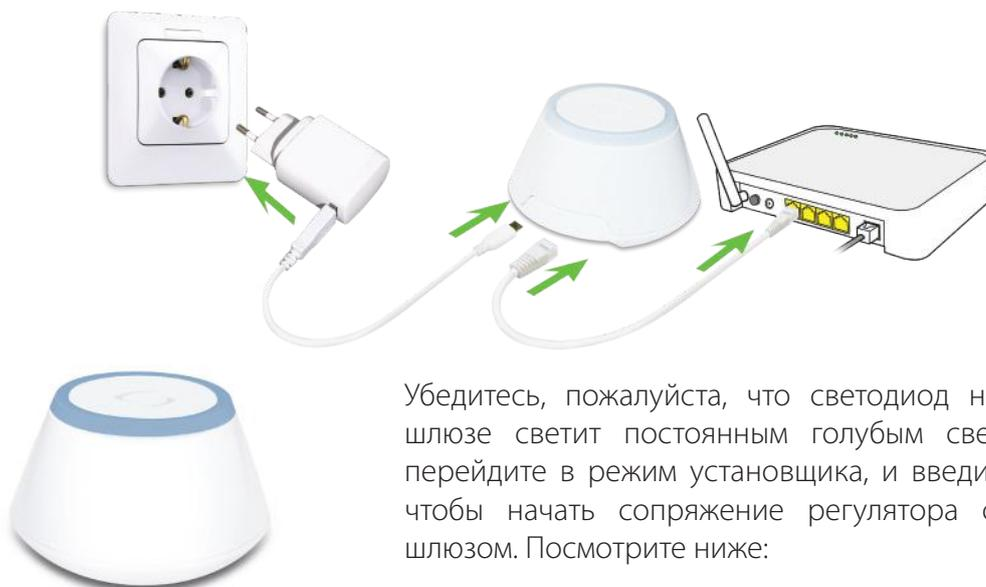
Убедитесь, пожалуйста, что светодиод на интернет шлюзе светит постоянным голубым светом. Затем перейдите в режим установщика, и введите код "55", чтобы начать сопряжение регулятора с интернет шлюзом. Посмотрите ниже:
