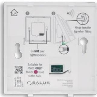
Задняя панель регулятора FC600
