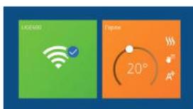
Цвет кафеля в главной панели изменится, когда регулятор будет работать в режиме нагрева и нагрев будет включен (оранжевый цвет).
