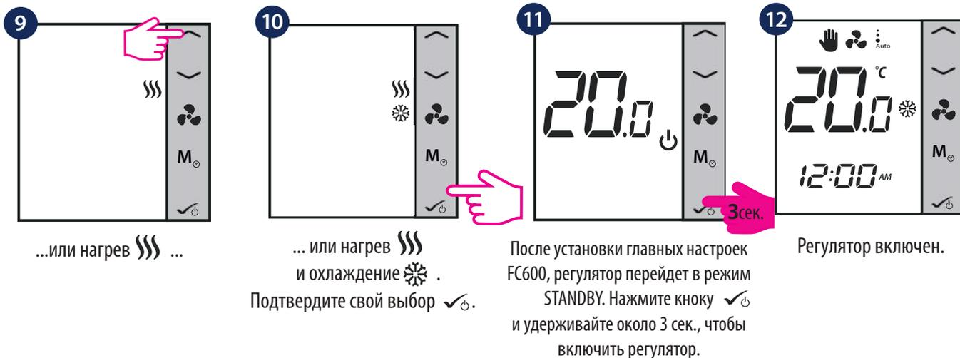
**ВАЖНО:** Шаги 8-10 (выбор режима нагрев/охлаждение или оба) доступны только в случае ручного изменения режимов нагрев/охлаждение. Если в шаге 6 выберёте режим автоматического выбора или HCCO, регулятор пропустит эти настройки и перейдет в режим ожидания (STANDBY). Во время первой установки, регулятор необходимо конфигурировать соответственно тому, что подключено к клеммам S1 и S2.
