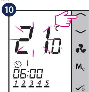
Задайте температуру для 1 программы с помощью кнопок ^ или v.
