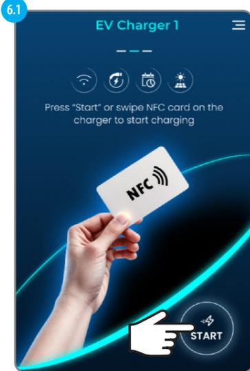
Verbinden Sie das Ladekabel mit dem Elektrofahrzeug und dem Ladegerät. Wischen Sie mit der NFC-Karte über das Ladegerät, oder wählen Sie Start, um den Ladevorgang zu starten.
