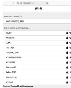
Wählen Sie auf der Seite für die Wi-Fi-Einrichtung ein Netzwerk aus der Liste aus und geben Sie das Passwort ein, um das Ladegerät zu verbinden.
