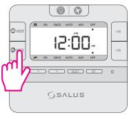
Appuyez sur le mode CH pour le chauffage central
