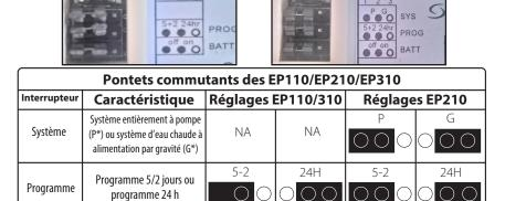
\* P - P - Système entièrement à pompe pour le chauffage central et l'eau chaude indépendants.
