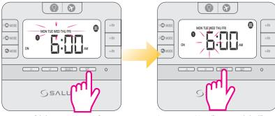
Appuyez sur Régler et sur Haut ou Bas pour sélectionner les jours de la semaine ou les weekends. Appuyez sur Sélectionner pour confirmer. Appuyez sur Haut/Bas pour régler l'heure. Appuyez sur Sélectionner pour confirmer.
