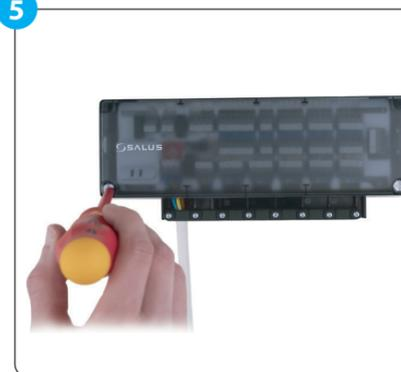
Assurez-vous que tous les fils sont correctement connectés, montez le couvercle supérieur et mettez le boîtier de contrôle sous tension - le voyant rouge d'alimentation s'allume.
