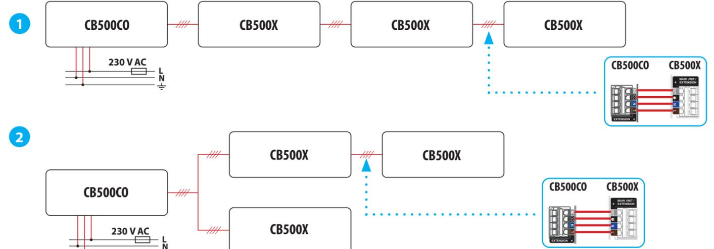
**WARNUNG!** Schließen Sie das Netzteil NICHT an den Netzteileneingang der CB500X an, wenn diese zusammen mit der CB500CO angeschlossen ist. Der CB500X-Stromversorgungseneingang darf nur verwendet werden, wenn die CB500X als eigenständiges Gerät arbeitet.
