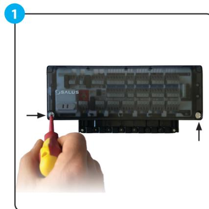
Entfernen Sie die obere Abdeckung der Klemmleiste
