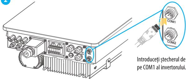
Introduceți ștecherul de aviație pe COM1 al invertorului.
