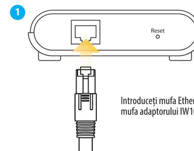
Introduceți mufa Ethernet RJ45 în mufa adaptorului IW10.
