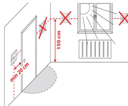
**⚠️ Remarque:** La position idéale pour le montage du thermostat est d'environ 1,5 m au-dessus du sol et loin des sources de chauffage ou de refroidissement. Le thermostat ne doit pas être exposé à la lumière du soleil ou à des conditions extrêmes, comme des courants d'air ou des vents directs.
