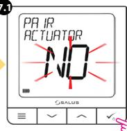
7.1 L'appareil demandera à être apparié à un moteur/registre s'il ne l'a pas encore été. Si vous choisissez « NON », appuyez sur le bouton [Validation], l'appareil restera sur le même écran.
