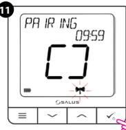
11 Au cours de ce processus, il est prévu de lancer le processus d'appariement dans la zone spécifique du boîtier de commande. Le thermostat commencera automatiquement à s'appairer avec cette zone.
