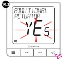
10.2 Si vous choisissez « Oui » et appuyez sur le bouton [Validation], l'appareil passera à l'étape suivante pour lancer automatiquement le processus d'appariement.
