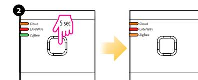
Pour démarrer l'installation du système, appuyez sur le bouton et maintenez-le enfoncé pendant 5 secondes jusqu'à ce que le voyant ZigBee devienne orange fixe. Cela signifie que le réseau ZigBee est prêt à accepter les appareils Salus Premium.
