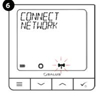
6 L'appareil détectera automatiquement le réseau zigbee et s'y connectera. Si l'appareil se connecte au réseau avec succès, il passera à l'étape suivante.
