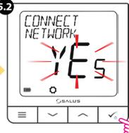
5.2 Se connecter au réseau ZigBee. Si le choix est « OUI », appuyez sur la coche de validation, l'appareil commencera automatiquement le processus de connexion.
