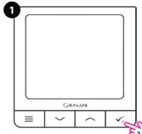
1 Lorsque l'appareil est mis sous tension, l'écran LCD est éteint (il n'affiche rien). Appuyez sur le bouton [OK] pendant 3 secondes pour l'allumer.
