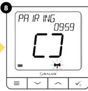
8 Pendant ce processus, le thermostat lancera automatiquement l'appariement avec le moteur de la zone en question. (Sur le boîtier de commande du plénum)
