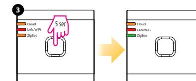
Lorsque tout est apparié, appuyez sur le bouton et maintenez-le enfoncé pendant 5 secondes jusqu'à ce que le voyant ZigBee devienne vert fixe. Si vous souhaitez remplacer ou ajouter de nouveaux appareils, assurez-vous de suivre les étapes 2 et 3.
