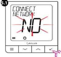
5.1 Se connecter au réseau ZigBee. Si le choix est « NON », appuyez sur la coche de validation, l'appareil restera sur le même écran.
