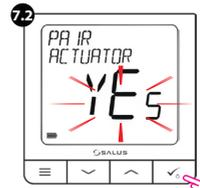
7.2 L'appareil demandera à être apparié à un moteur/registre s'il ne l'a pas encore été. Si vous choisissez « OUI » et appuyez sur le bouton [Validation], l'appareil passera à l'étape suivante pour lancer automatiquement le processus d'appariement.
