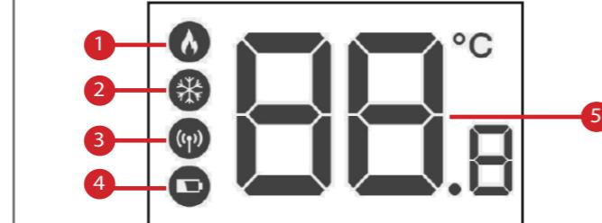
1 Regulator komunikuje zapotrzebowanie na ogrzewanie
