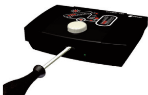
Fig. 11.1 Deschiderea carcasei controller-ului
