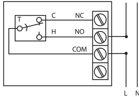
Terminal NO pour une utilisation en mode chauffage. Terminal NC pour un mode refroidissement.
