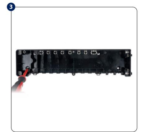
Fixez le côté arrière du boîtier au mur. Lors du montage sur un rail DIN, ouvrez les crochets situés à l'arrière du boîtier.
