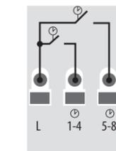
Deux horloges externes. Une pour le groupe 1 et une pour le groupe 2 (deux horloges externes + thermostats non-programmables, par exemple VS35).
