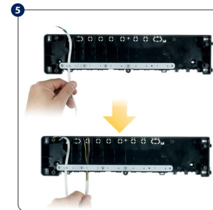
Enfiler les fils sous la ceinture de montage dans la partie arrière du centre de câblage.
