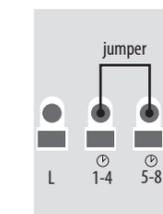
Un thermostat principal maître aux thermostats des groupes 1 et 2 (un thermostat programmable, par exemple VS30, les autres thermostats ne sont pas programmables, par exemple VS35).
