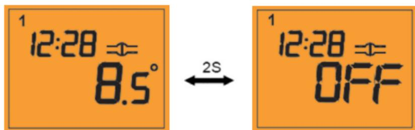
Wenn der Ventilschutz aktiv ist wird dieser auch im "OFF" Betrieb aktiv sein. Die Lüftungsfunktion ist im „OFF“ Betrieb deaktiviert.
