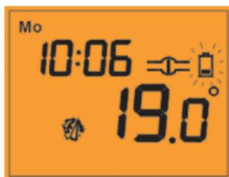
Dieser Indikator wird solange angezeigt bis die Batteriespannung wieder ein normales Level hat. Die Beleuchtung wird bei niedriger Spannung nicht aktiviert, Wird dieses Symbol angezeigt sollten Sie bald möglichst die Batterien tauschen.
