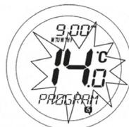
Zunächst werden die Uhrzeiteinstellungen vorgenommen. Dabei blinkt die Stundenanzeige der Uhrzeit, so dass diese leicht zu erkennen ist. Mit dem Touch-Ring können Sie die Uhrzeit auf den gewünschten Wert einstellen. Drücken Sie dann OK, um die Auswahl zu bestätigen.
