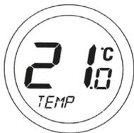
Der NORMAL-Modus ist an, wenn die Raumtemperatur angezeigt wird; wenn sich der ST620 im NORMAL-Modus befindet und Sie den Touch-Ring an irgendeiner Stelle außer an der Taste OK und der Pfeiltaste berühren, können Sie die eingestellte Solltemperatur überprüfen.
