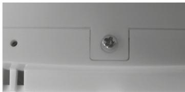
Nach dem Aufschrauben trennen Sie vorsichtig die beiden Hälften des Gehäuses, indem Sie die Rückseite leicht nach oben schieben. Nachdem Sie das Gehäuse geöffnet haben, sollten Sie nun die Batterien erkennen:
