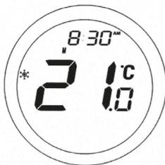
Wenn sich der Thermostat ST620 im Frostschutz-Modus befindet, wird auf der LCD-Anzeige sowohl die Raumtemperatur, als auch das Frostschuttsymbol angezeigt. MANUAL oder AUTO wird nicht angezeigt.
