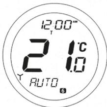
Die Zeit- und Wochentageinstellungen des ST620 werden jeden Tag automatisch (um 00:00 oder 02:00 Uhr) durch die eingebaute sehr genaue Funkuhr (RCC) aktualisiert.
