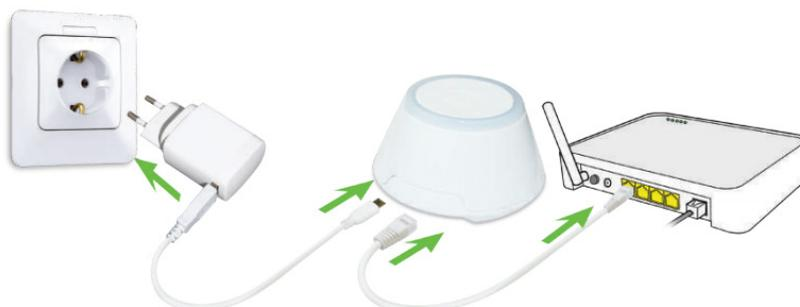
Um mit dem Kopplungsprozess zu beginnen, sollte das Gateway an die Stromversorgung angeschlossen und mit dem Internet verbunden sein. Stellen Sie außerdem sicher, dass das UGE600 zu Ihrer Salus Smart Home App hinzugefügt wird. Für die Installation des Universal-Gateways lesen Sie bitte das UGE600-Handbuch auf [salus-manuals.com](http://salus-manuals.com)
