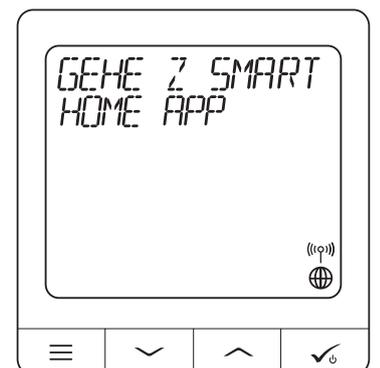
Das Thermostat ist angeschlossen. Gehen Sie zur Smart Home-App um sie zu konfigurieren.
