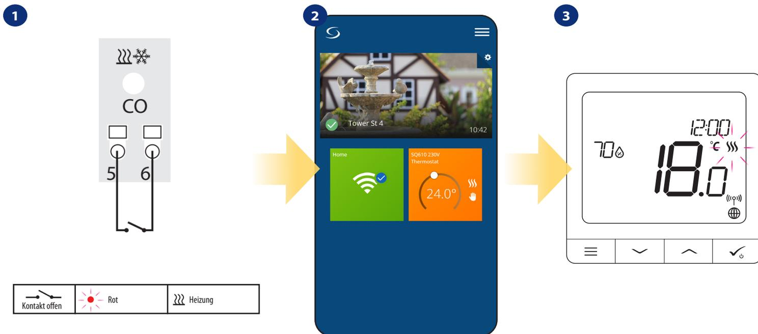
Wenn keine Steckbrücke an der „CO“-Klemme vorhanden ist, arbeitet die Klemme KL08RF automatisch im Heizmodus.
