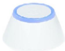
Stellen Sie sicher, dass Ihr Universal Gateway UGE600 zur App hinzugefügt wird. Die LED des Gateways sollte stetig blau leuchten. Dann Gehen Sie zum Thermostat SQ610 und beginnen Sie den Kopplungsprozess mit dem UGE600 und fügen Sie es der App hinzu.
