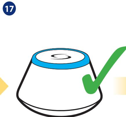
Das Gateway hört auf zu blinken und schaltet auf stetig blaue Farbe, was bedeutet, dass der Kopplungsprozess beendet wurde.
