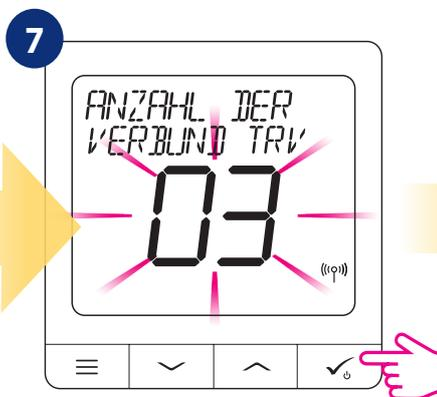
Auf der LCD-Anzeige sehen Sie die Anzahl de gekoppelten TRV's. Wenn alle TRV's gekoppelt sind - drücken Sie
