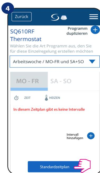
Um den Standardzeitplan festzulegen, verwenden Sie die Schaltfläche „Standardzeitplan“. Dadurch werden alle aktuellen Intervalle entfernt und der Standardzeitplan festgelegt.
