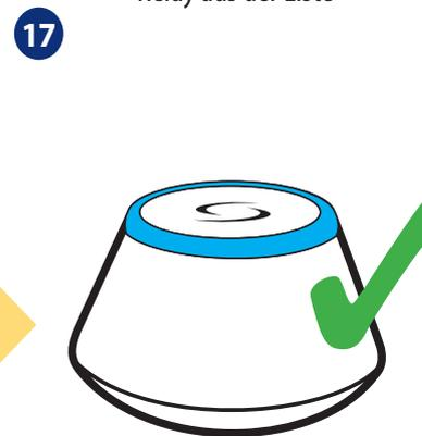
Das Gateway hört auf zu blinken und schaltet auf stetig blaue Farbe, was bedeutet, dass der Kopplungsprozess beendet wurde.
