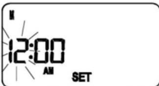
Drücken Sie "SET" und "SELECT" für ein paar Sekunden, während sich der RT500 Funk im Normal-Modus befindet, um in den Einstellmodus für die Uhr zu gelangen. Lassen Sie beide Tasten wieder los und die Anzeige wird das nebenstehende Bild darstellen:
