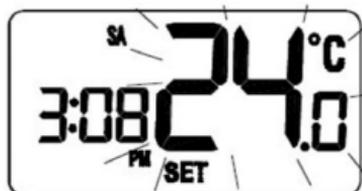
Drücken der Aufwärts-Taste erhöht den Wert - Drücken der Abwärts-Taste verringert den Wert der Soll-Temperatur in 0,5°C Schritten - die Soll-Temperatur kann zwischen 10°C und 35°C eingestellt werden.
