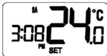
Beim temporär-manuellen Modus der programmierten Temperatur im Betrieb wird die LCD-Anzeige die aktuelle Soll-Temperatur anzeigen:
