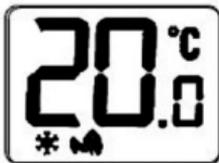
Wenn der Frostschutzmodus eingeschaltet ist, wird die Frostschutz-Anzeige erscheinen und in der folgenden Reihenfolge blinken:
