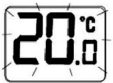
Sie können die Soll-Temperatur leicht ändern, während Sie sich die Soll-Temperatur anzeigen lassen. Drücken Sie die Aufwärts- oder Abwärts-Taste wiederholt, um die Temperatureinstellung zu ändern. Die Solltemperatur blinkt, um anzuzeigen, dass sie eingestellt werden kann:
