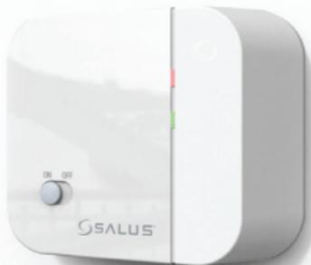
An der Vorderseite des Empfängers sehen Sie zusätzlich zum Ein/Aus-Schalter noch zwei LEDs (Light Emitting Diodes). Der Schalter ermöglicht es Ihnen den Empfänger, wenn nötig, auszuschalten, um die Wärmeanforderung zu verhindern. Die obere LED (rot) leuchtet auf, wenn der Schalter sich in der "On"-Position befindet und das Gerät über eine Stromversorgung verfügt. Die untere LED (grün) leuchtet auf, wenn der Empfänger eine Information über die aktivierte Funktion "Heizen" vom RT300 Funk empfängt.
