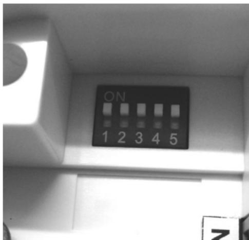
Um den Funk-ID-Code der Bedieneinheit zu ändern, entfernen Sie bitte eine oder mehrere der Jumper-Kappen auf der Rückseite der Einheit (nummeriert 1,2,3,4 und 5 wie auf dem Bild dargestellt), so dass diese Jumper-Einstellungen mit denen auf dem Empfänger übereinstimmen:
