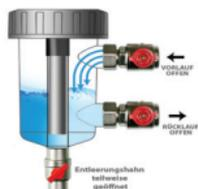
Während der Filter sich mit Wasser füllt wird die Luft nach oben gedrückt.
