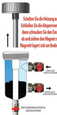
Öffnen Sie das Entleerungsventil um die Magnetite und das restliche Wasser aus dem Gehäuse abzulassen.
