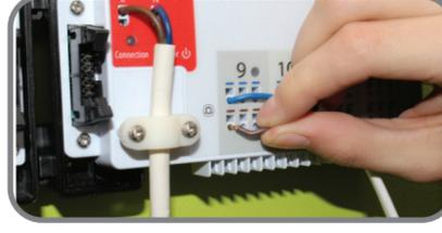
Brechen Sie die Aussparung für die Anschlussleitung der KL04RF heraus.
