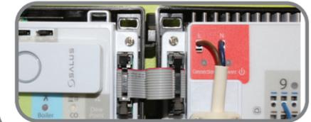
**13** Schalten Sie die Stromzufuhr zur KL04RF ein. Die rote LED leuchtet auf.
