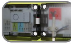
**2** Entfernen Sie die weiße Anschlussplatine.
