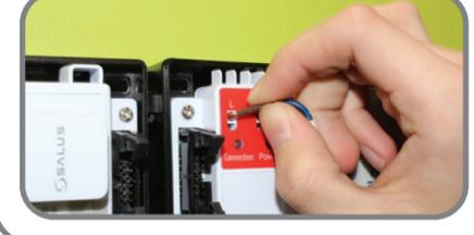
Entfernen Sie die Kunststoffabdeckung an der KL08RF.
