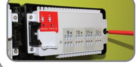
**8** Montieren Sie die Anschlussleitungen der Stellantriebe in die Anschlussklemmen der KL08RF für Stellantriebe. Sie können in jeder Zone bis zu vier Stellantriebe anschließen.
