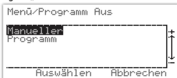
Wenn Sie „Programm Aus“ wählen, wird der programmierte Betrieb des ERT50T Triac gestoppt, bis der Benutzer erneut „Programm Ein“ auswählt. Alle Urlaubsbetriebeinstellungen werden abgebrochen und der Urlaubsbetrieb kann nur ausgewählt werden, wenn erneut „Programm Ein“ ausgewählt wird.
