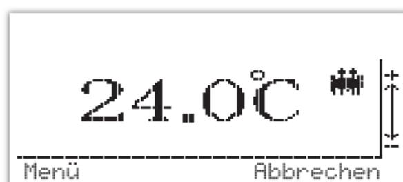
Durch Drücken der Taste „+“ bzw. „-“ kann die Solltemperatur erhöht bzw. verringert werden, wie in den nachstehenden Beispielen gezeigt:
