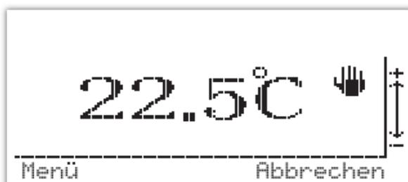
Wenn die Solltemperatur geändert wird, wird die programmierte Solltemperatur vorübergehend überschrieben und die programmierte Temperatur wird aktiv, sobald der nächste programmierte Schaltpunkt erreicht wird.
