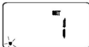
Jedes Drücken der +1Hr-Taste erhöht den Zeitraum des Override um eine weitere Stunde. Der maximale Zeitraum beträgt neun Stunden. Falls Sie den Wert über neun Stunden hinaus erhöhen, ändert sich die Einstellung auf 0 und der temporäre Override wird deaktiviert.
