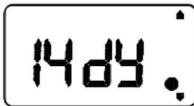
Falls die SET-Taste oder für länger als 3 Sekunden keine Taste betätigt wird, wird der Urlaubs-Override-Modus aktiviert und das Heizsystem schaltet sich sofort ab. Die Anzeige des EP101 wird daraufhin die
