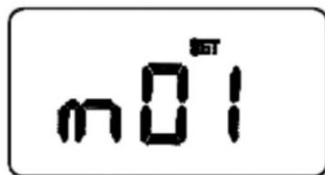
Drücken Sie die AUSWAHL-Taste, um den Monatsabschnitt des Datums aufzurufen - dieser wird auf dieselbe Weise durch die NACH OBEN- und NACH UNTEN-Tasten ausgewählt - gültige Einstellungen liegen zwischen 01 und 12
