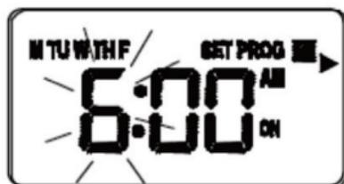
Betätigen Sie die NACH OBEN- oder NACH UNTEN-Taste, um die Stundeneinstellung auf den gewünschten Wert anzupassen und bestätigen Sie Ihre Auswahl durch Betätigen der AUSWAHL-Taste.
