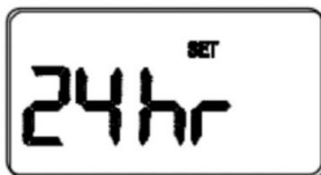
Lassen Sie die SET- und AUSWAHL-Tasten los und betätigen Sie die NACH OBEN- oder NACH UNTEN-Taste um zwischen dem 12- und 24-Stundenformat hin- und her zu schalten.
