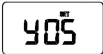
Betätigen Sie die NACH OBEN- oder NACH UNTEN-Taste, um die Jahreszahl zu erhöhen oder zu verringern - gültige Einstellungen liegen zwischen 05 und 99 (Anzeige von 2005 bis 2099).
