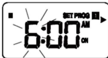
Das Betätigen der SET-Taste im Programmiermodus bringt den EP101 zurück in den Normal-Modus. Drücken Sie die AUSWAHL-Taste, um die Tagesauswahl zu bestätigen. Nachdem diese eingestellt wurde, blinkt die "Hour" (Stunden)-Anzeige
