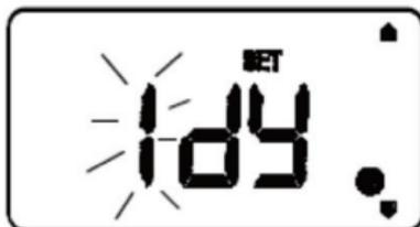
Sie können nun durch die NACH OBEN- und NACH UNTEN-Tasten die Anzahl der Tage, während denen das System abgeschaltet ist, erhöhen oder verringern. Die maximale Tagesanzahl beträgt 31 -
