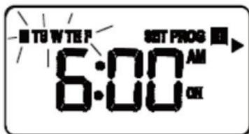
Drücken Sie die AUSWAHL-Taste, um die Wochentag- oder Wochenendauswahl zu bestätigen. Nachdem diese eingestellt wurde, blinkt die "Hour" (Stunden)-Anzeige und zeigt damit an, dass diese ausgewählt ist und angepasst werden kann:
